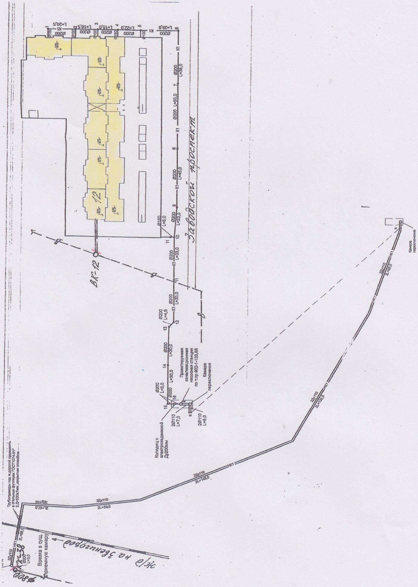
Трубопроводы под ж. дорогой проложить в стальных футлярах ГОСТ 1074-41 2 Д=450х7мм, закрытым способом
